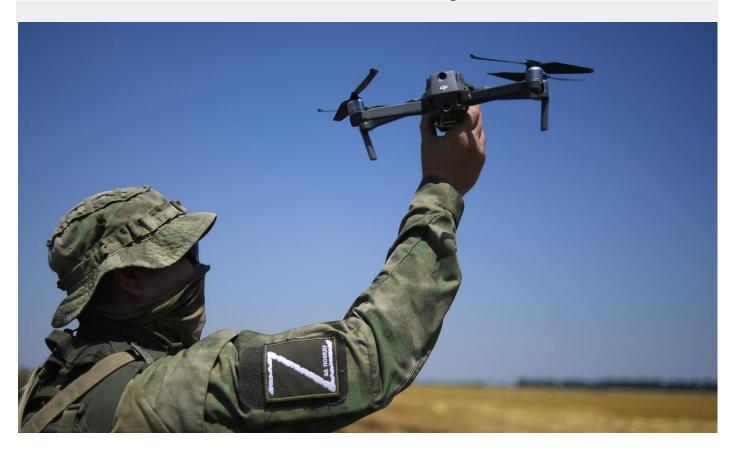
Беспилотное воздушное судно — это искусственный мобильный объект (летательный аппарат), как правило, многоразового использования, не имеющий на борту экипажа (человека-пилота) и способный самостоятельно целенаправленно перемещаться в воздухе для выполнения различных функций в автономном режиме (с помощью собственной управляющей программы) или посредством дистанционного управления, осуществляемого человеком-оператором со стационарного или мобильного пульта управления.
